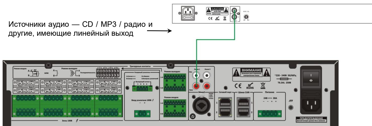
Рис. 4.1. Схема подключения источника аудиосигнала к линейным входам усилителя мощности LPA-EVA-8500
