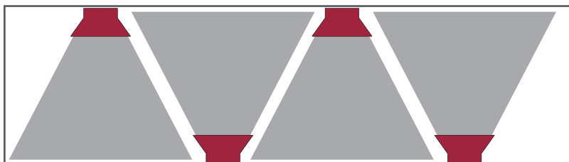
Схема озвучивания помещения обычным настенным громкоговорителем
