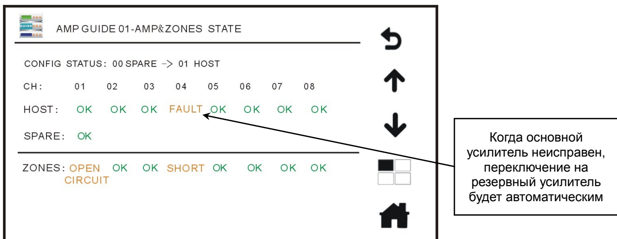
Рис. 4.13. Состояние переключения на резервный усилитель в окне
