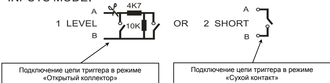
Рис. 4.16. Схема подключения цепей управляющих сигналов расположена на задней панели устройств LPA-EVA
